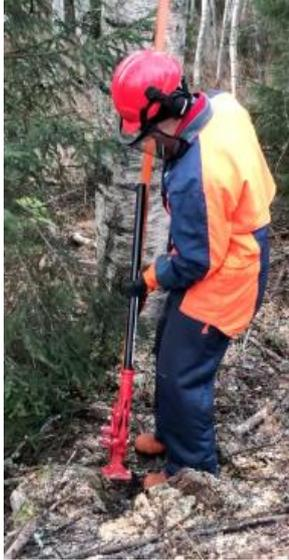
2. Gör en markering på ett träd och såga ett snitt för trädfällriktare tänder, se alltid till så du har en röjd reträtt väg bakåt som vid all träd fällning med motorsåg. Håll kombinationen av farmdomkraft och trädfällriktare så kort som möjligt.
