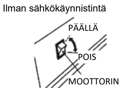
Palauta avain PÄÄLLÄ-asentoon, kun moottori on käynnistynyt. Älä käytä käynnistintä yhtäjaksoisesti yli 5 sekuntia. Jos moottori ei käynnisty, vapauta kytkin ja odota vähintään 10 sekuntia ennen kuin käytät käynnistintä uudelleen.
