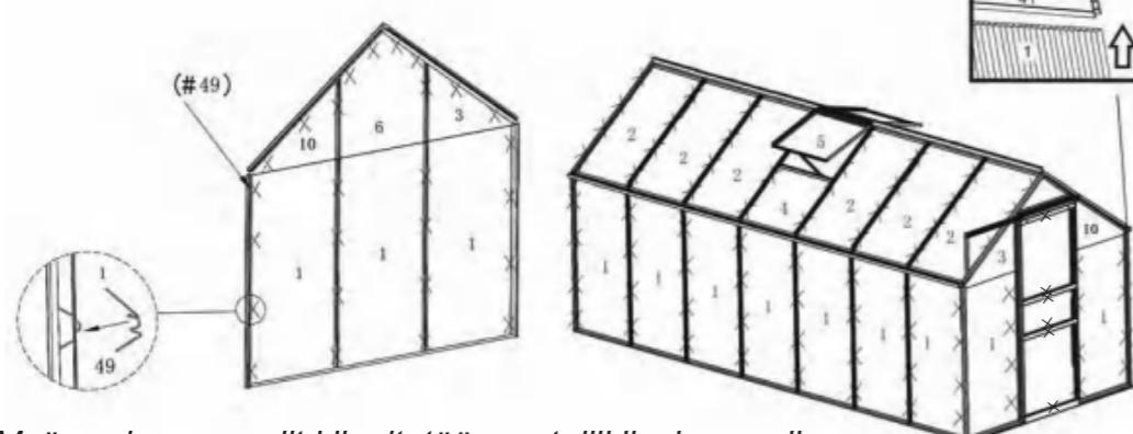
*Myös ovien paneelit kiinnitetään metalliklipsien avulla.*
