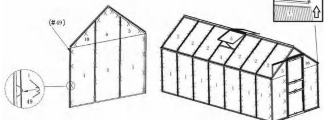
Dörrpanelerna är också fästa med metallklämmor.
