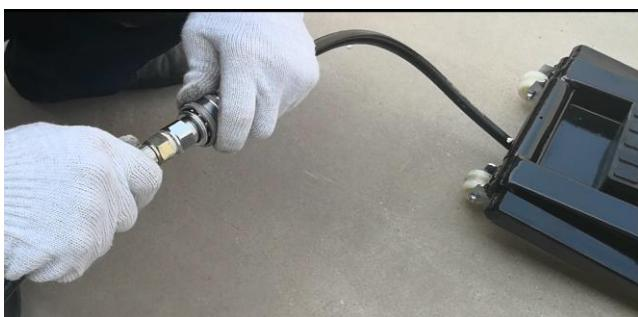
Käännä nostin ylösallasin. Kytke voimayksikkö päälle. Kytke pistoke 230 V / 50 Hz pistorasiaan. Paina ylös-painiketta, kunnes nostin on yläasennossa. Paina alas-painiketta, kunnes nostin on ala-asennossa. Toista tämä 2-3 kertaa. Poista ilma letkusta ja sylinteristä (sylinteri lakkaa liikkumasta hitaasti). Käännä nostin oikein päin.
