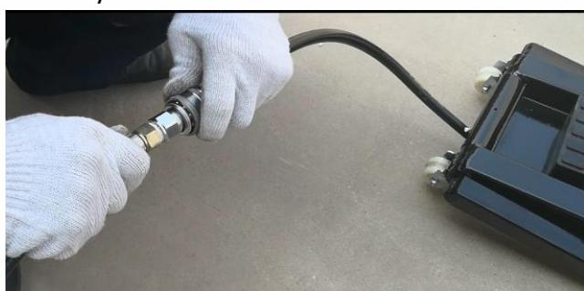
Vänd lyften upp och ner. Slå på kraftenheten. Anslut kontakten till ett 230 V / 50 Hz-uttag. Tryck på upp-knappen tills lyften är i upplyft läge. Tryck på ned-knappen tills lyften är i sänkt läge. Upprepa detta 2-3 gånger. Avlägsna luften från slangen och cylindern (cylindern slutar röra sig långsamt). Vänd lyften rätt väg.
