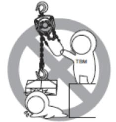
5. ÄLÄ KOSKAAN nostaa tai kuljeta kuormia ihmisten yläpuolella tai lähellä.
