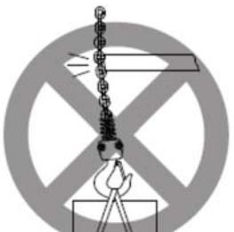
Låt inte lyftkedjan passera igenom lastens (till exempel en stålplåts) yta.
