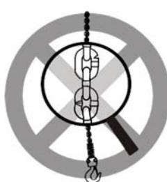
Det är förbjudet att använda ett kedjeblock med deformationer eller sprickor i lyftkedjan
