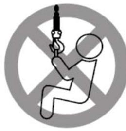
Lyftblocket får inte användas för att transportera personer eller användas som stödmekanism.
